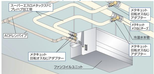
あらかじめ両管端にねじ継手をプレハブ接続。ファンコイルユニット回りの配管をプレハブ化します。
