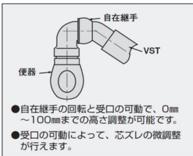
18) エスロン透明DV継手 (排水用硬質ポリ塩化ビニル管継手) [JIS K 6739]
